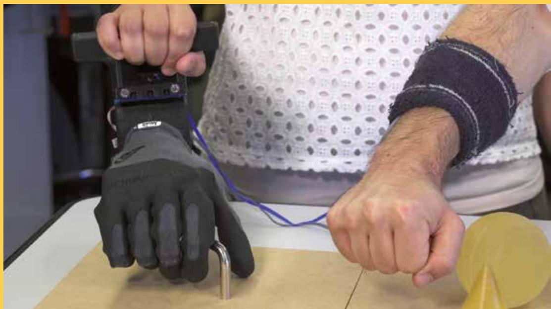
**SoftHand è un prototipo di mano robotica che riesce a coniugare un’architettura molto semplice con una funzionalità molto simile a quella della mano umana. È stata pensata per realizzare sia protesi robotiche che sistemi di presa industriali.**
