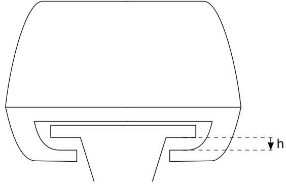
La dinamica verticale del veicolo a levitazione magnetica rappresentato in figura può essere modellata con buona approssimazione come un sistema composto da due parti: una sorgente di campo magnetico generato dalla corrente  $i(t)$  che circola in una induttanza  $L$  e una massa  $m$  di materiale ferromagnetico sottoposta sia alla forza peso che alla forza magnetica. Tale modello può essere descritto dal seguente sistema di equazioni differenziali ordinarie
