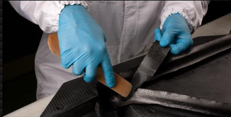
Esiste un insieme di processi di formatura più comuni, impiegati per componenti normalmente di grandi dimensioni, che prevede la laminazione delle pelli a secco e una successiva infusione di resina (RTM). L'insieme di tali processi è chiamato «**Wet Lay-Up**».
