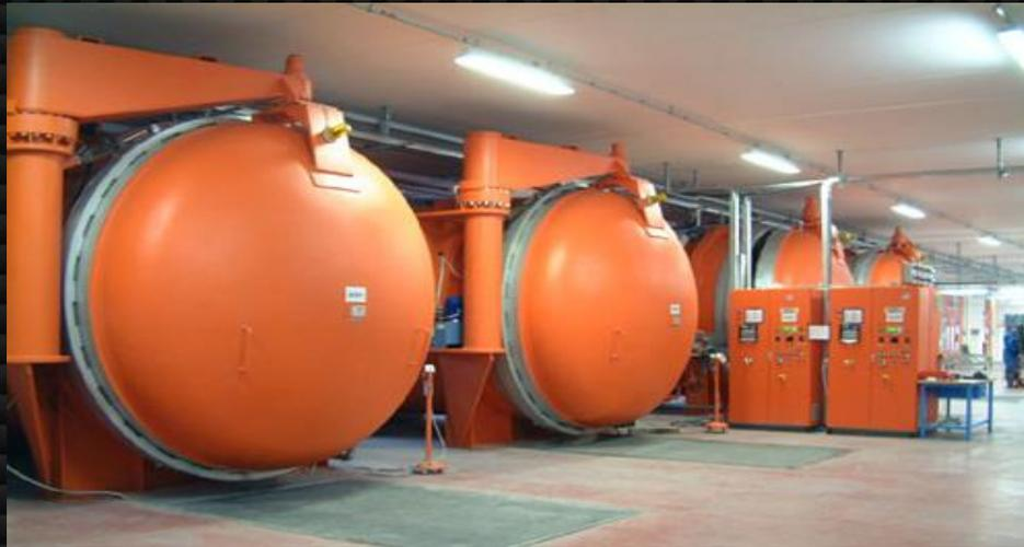
Nei cicli standard la camera dell'autoclave è **pressurizzata con aria**. Essendo tuttavia la reticolazione un processo con forte produzione di calore e conseguente possibilità di autocombustione del materiale in taluni casi è preferibile l'utilizzo di gas inerti.
