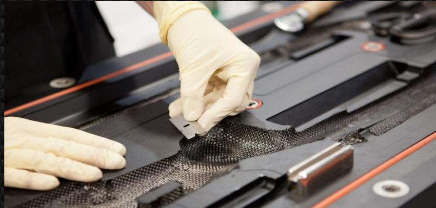
Le tecnologie di formatura sono tutti quei processi produttivi **caratterizzati da una deposizione del composito (fibre e matrice) su di uno stampo** opportuno che conferisce allo stesso la forma desiderata a seguito di un processo di polimerizzazione.
