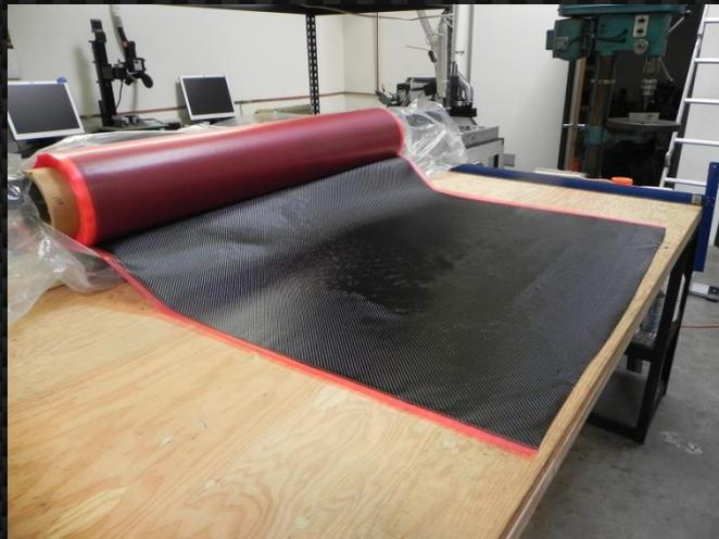
Questo è fornito sotto forma di rotoli di larghezze predefinite e viene stoccato in cella frigorifera (tra i  $-18^{\circ}$  e i  $-22^{\circ}$ ) per rallentare il **processo di reticolazione** della resina, che è già innescato.
