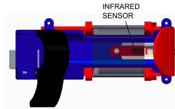
(d) Infrared sensor placement.
