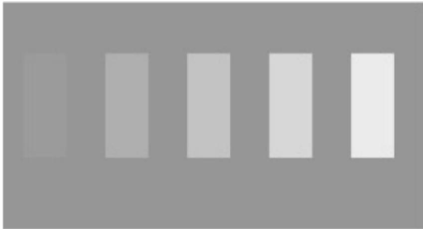
In figura è riportato un tipico esperimento per la valutazione del JND, la prima barra ha un JND del 3% (R Rangayyan, Biomedical Image Analysis, CRC Press 2004). Si fanno dei test di qualità con fantocci che implementano diverse JND che prevedono il riconoscimento del numero massimo possibile di inserti da parte dell'operatore o del sistema di acquisizione.
