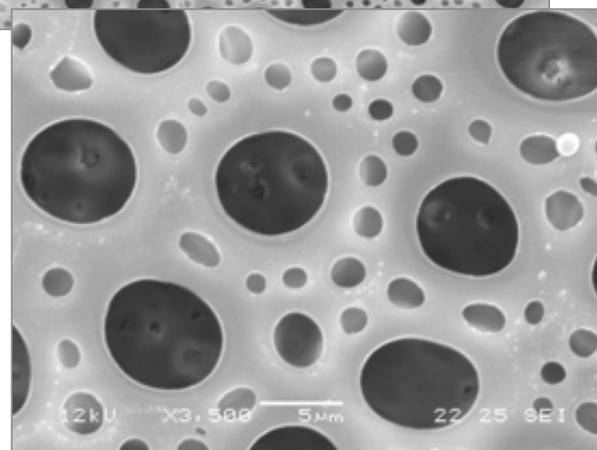
**Membrana in PMMA ottenuta da soluzione omogenea trifase PMMA-THF-H<sub>2</sub>O invertita per evaporazione controllata del solvente (*MINOR CONCENTRAZIONE*)**
