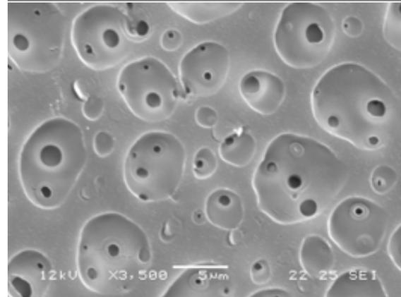
**Membrana in PMMA da soluzione in DMSO invertita in H<sub>2</sub>O**
