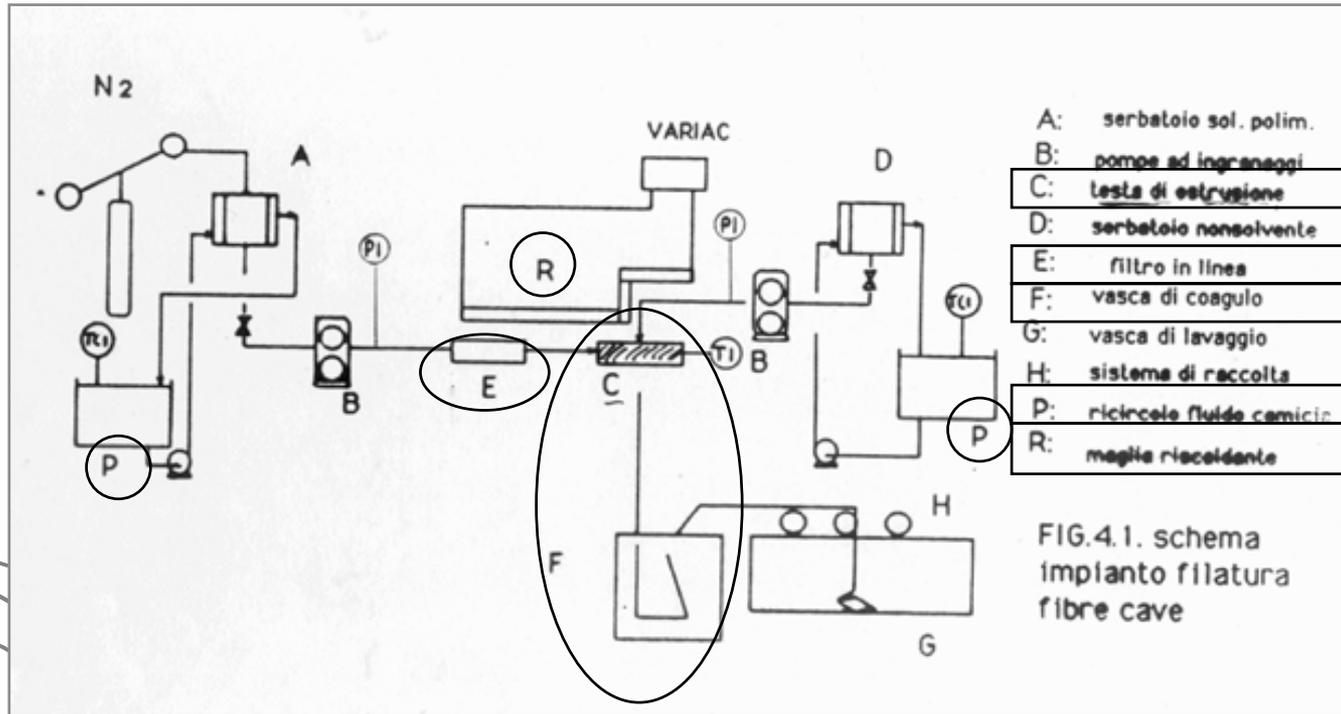
Schema impianto filatura FIBRE CAVE.
