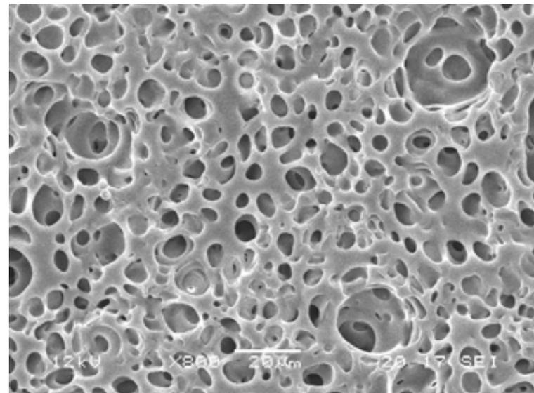
**Membrana in PMMA ottenuta da soluzione omogenea trifase PMMA-THF-H<sub>2</sub>O invertita per evaporazione controllata del solvente**
