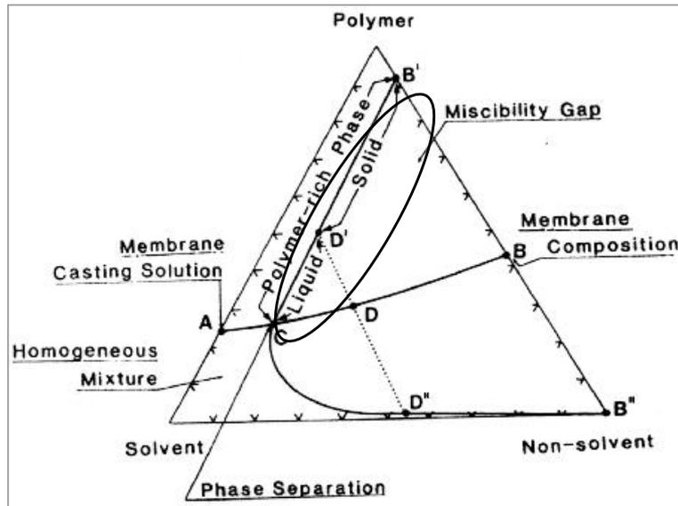
I punti C, D e B rappresentano rispettivamente il punto di precipitazione, il punto di solidificazione e la composizione finale della membrana. Durante la precipitazione è possibile distinguere tre strati all'interno della soluzione:
