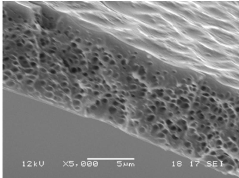
**Membrana in PMMA da soluzione in THF invertita in H<sub>2</sub>O**
