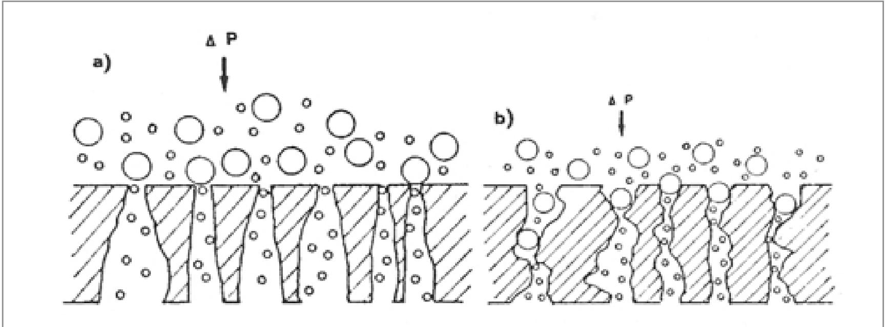
Rappresentazione schematica delle caratteristiche di filtrazione per una membrana (a) **simmetrica** e (b) **asimmetrica**
