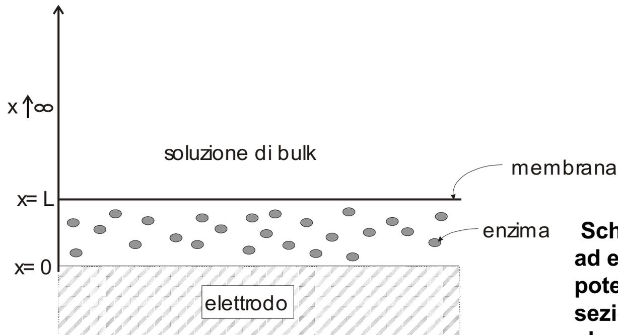
**Schema semplificato biosensore ad enzima con lettura potenziometrica riportato in sezione. Si considera un sistema planare, con elettrodo posto a  $x=0$  e la membrana a  $x=L$ . La soluzione si estende fino a  $x=\infty$ .**
