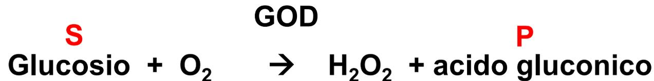
La concentrazione del prodotto può essere determinata con diversi metodi, una dei più utilizzati è quello elettrochimico in cui viene misurato la diminuzione di pH dovuta al prodotto (acido gluconico). Un'altra possibilità è quella di rilevare una riduzione locale della pressione parziale di O<sub>2</sub>
