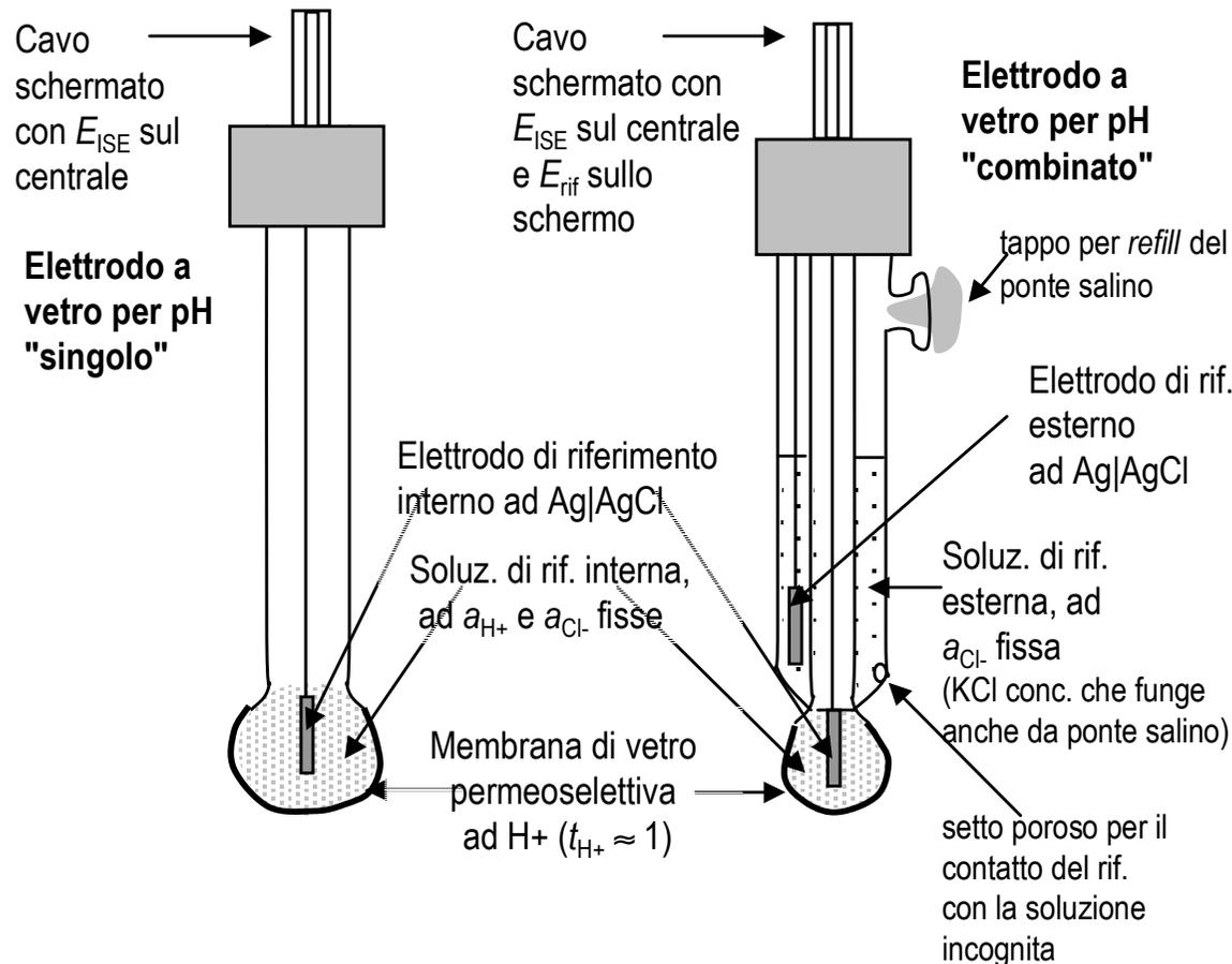
Il cosiddetto modello “combinato” dell’elettrodo a vetro porta, per comodità, una seconda camicia contenente l’elettrodo e la soluzione di riferimento esterni, che comunicano con la soluzione esterna tramite un setto poroso. Si tratta a tutti gli effetti di una coppia di elettrodi, e il cavo che va allo strumento porta sul centrale il segnale dell’elettrodo a vetro e sulla guaina metallica esterna il segnale dell’elettrodo di riferimento.
