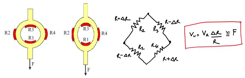
Per la misura della forza F: 4 estensimetri lungo l'anello, F provoca l'allungamento di R2, R4 e una compressione di R1, R3
