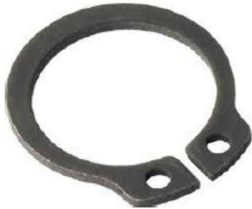
Gli *anelli elastici* sono realizzati con acciaio per molle, hanno forma circolare discontinua e vengono inseriti nella propria cava o sede per deformazione elastica.
