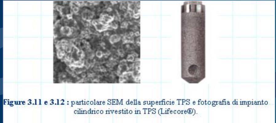
Figure 3.11 e 3.12 : particolare SEM della superficie TPS e fotografia di impianto cilindrico rivestito in TPS (Lifecore®).
