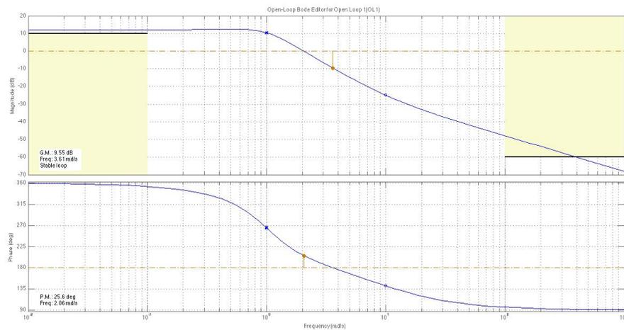
Figura 5: Diagrammi di Bode del sistema  $C(s)G(s)$  con  $C(s) = 0.04$ .
