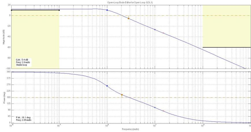
Figura 6: Diagrammi di Bode del sistema  $C(s)G(s)$  con  $C(s) = \frac{0.04}{1+0.067s}$ .
