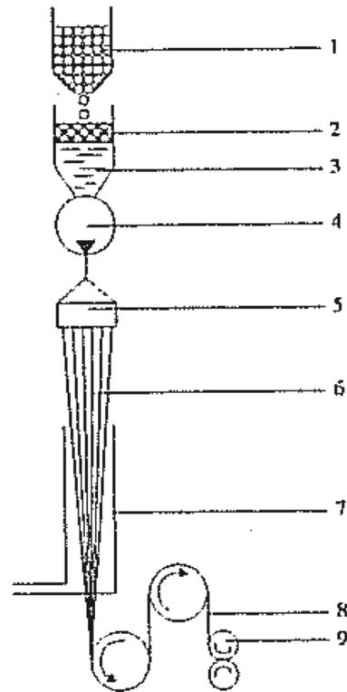
*Processo di fabbricazione della fibra multifilamento in PET.
