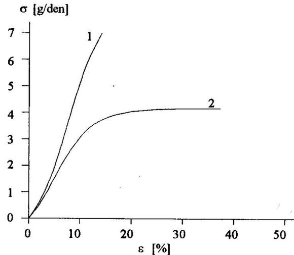
Figura 8.8 Caratteristiche sforzo-deformazione del Dacron stirato (1) e non stirato (2). Lo sforzo è in questo caso espresso in g/den dove den sta per denier che è la misura della sezione di fibra espressa come il peso in grammi corrispondente a 9000 m di lunghezza (da: L Harmon e MS Hoffman 'Fabrication and Testing of Polyester Arterial Grafts' in *Vascular Graft Update*, ed. KE Kambic, A Kantrowitz e P Sung, ASTM, Philadelphia, 1986).
