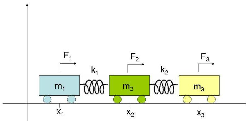
Figure 1: Modello dinamico formato da tre masse collegate da due molle.
