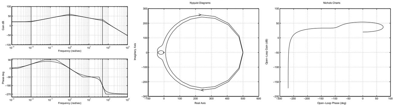
B) Poiché il sistema è a fase minima, si può procedere semplicemente con la sintesi sui diagrammi di Bode. Fissiamo un controllore  $C(s) = \frac{K}{s} C_0(s)$ , con  $C_0(0) = 1$ . Per soddisfare le specifiche statiche è necessario un polo nell'origine, quindi poniamo  $t = 1$ . La costante  $K$  viene determinata in base al requisito sull'errore a regime sulla rampa: tale errore è pari a  $\frac{1}{K 10\alpha}$ , quindi occorre che sia  $K \geq \frac{10}{\alpha}$ .
