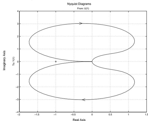
Per ogni valore di  $\alpha$ , il diagramma di Nyquist non circonda il punto  $-1 + j0$ ; ma la f.d.t. del sistema in anello aperto presenta una coppia di poli complessi a parte reale negativa ed un polo reale positivo, quindi il anche il sistema a ciclo chiuso è instabile.
